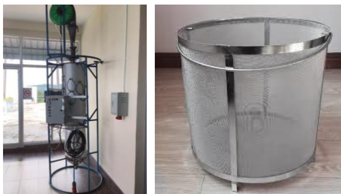
ภาพที่ 1 เครื่อง Air-impingement jet dryer และถาดตะแกรงที่ใช้ในการอบแห้ง
