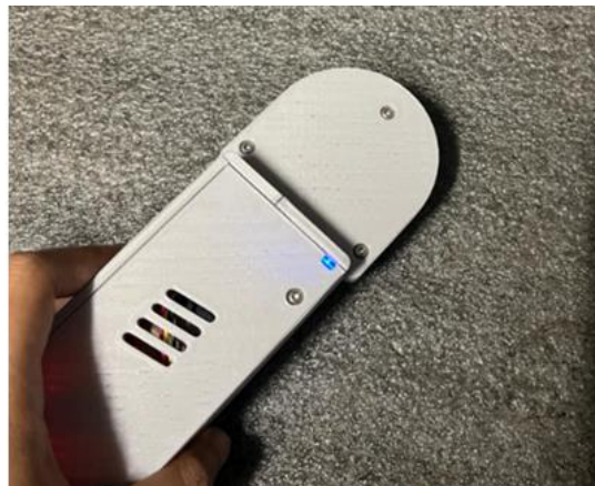
รูปที่ 10 เครื่องอ่าน RFID ในขณะกำลังอ่านข้อมูลจากชิปสัตว์
